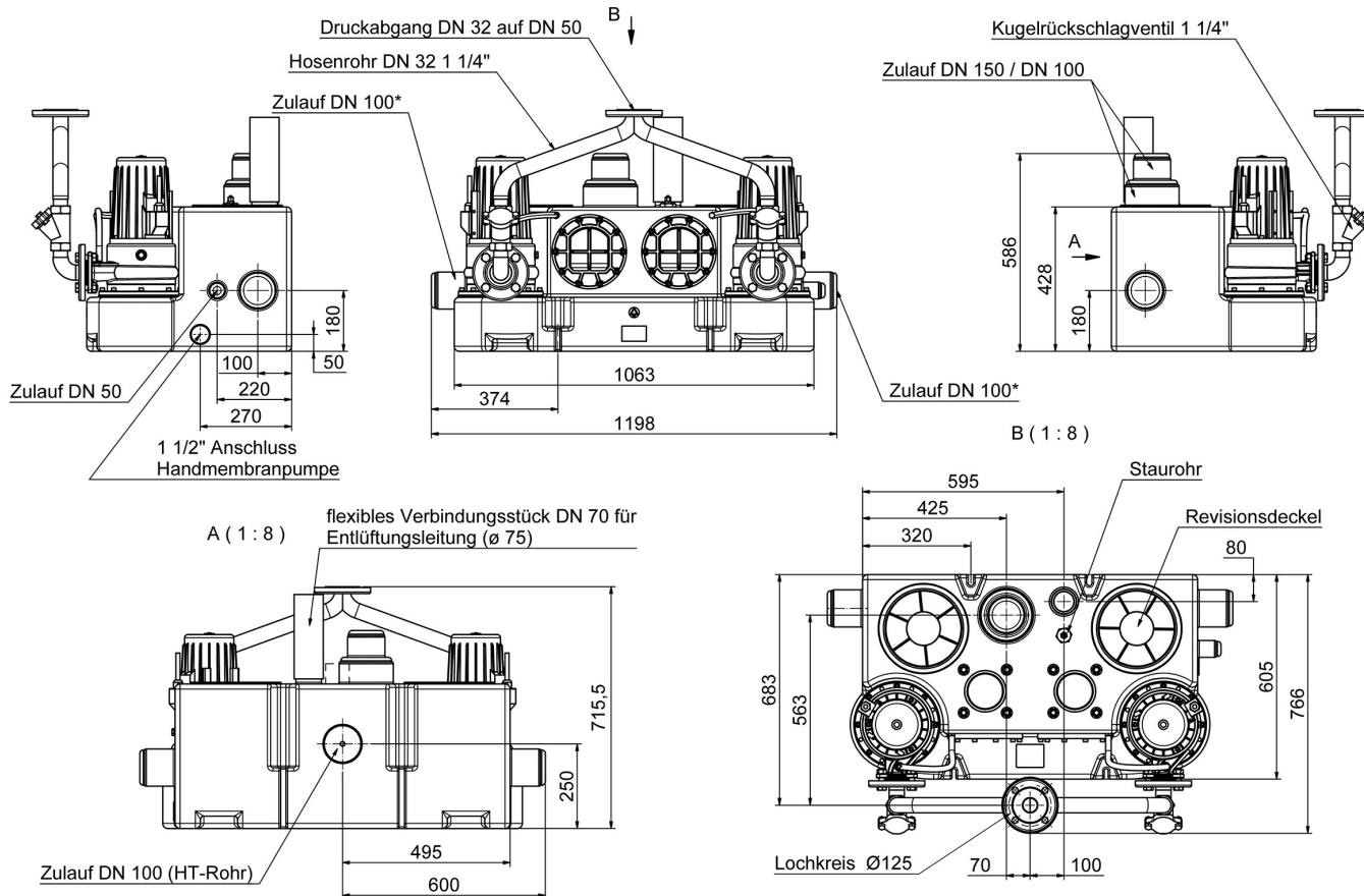
\* dieser Zulauf muss unmittelbar nach der Hebeanlage auf eine Höhe von 250 mm über Aufstellniveau geführt werden
